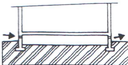
obr. 13 Objekt na vzduchovém polštáři - izolační podloží
